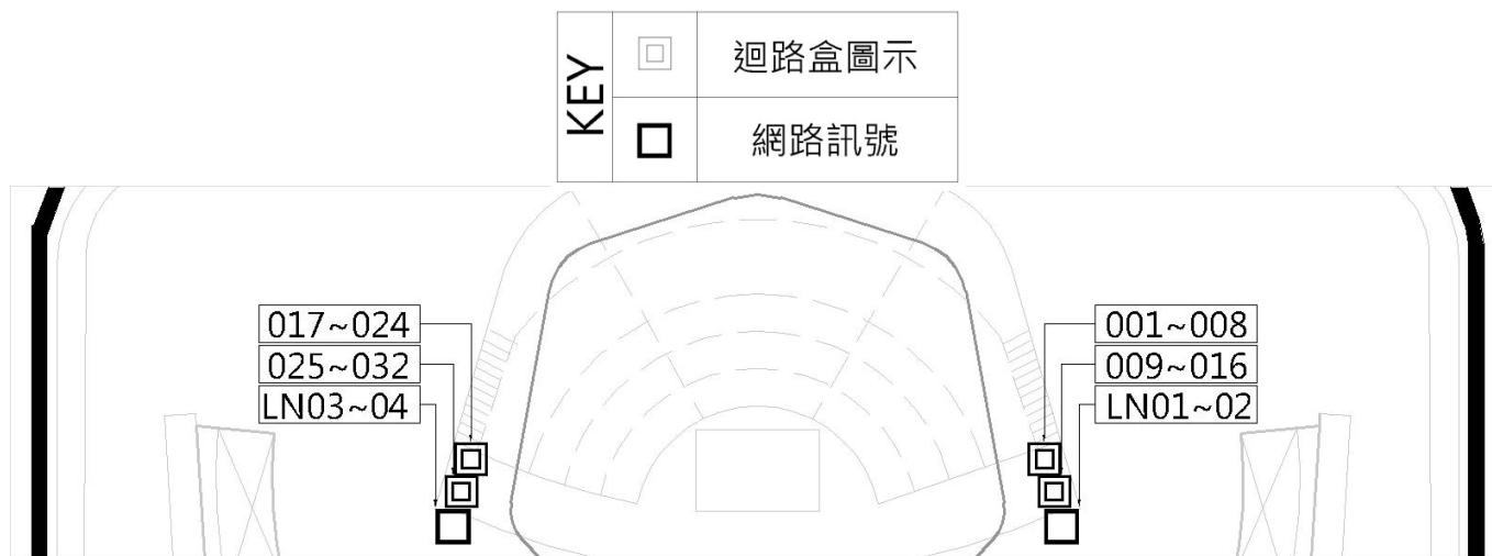
圖例 2.4.1 舞台區燈光迴路配置
